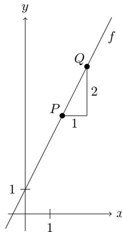
Wir sehen, dass die Steigung gerade das Verhältnis zwischen der vertikalen und der horizontalen Kathete des eingezeichneten rechtwinkligen Dreiecks ist. So ein Dreieck wird als *Steigungsdreieck* bezeichnet.
